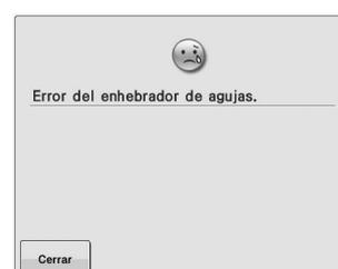
El mecanismo de enhebrado automático no funciona correctamente. Retire el hilo enredado en el mecanismo de enhebrado automático y, a continuación, toque
