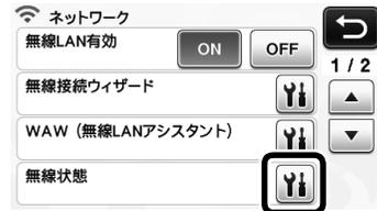
▶ 無線LANの接続状態、通信規格、電波状態、SSIDなどが表示されます。
