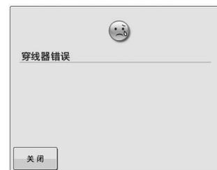
自动穿线装置无法正确运行。线缠在自动穿线装置内，请将线清除，然后触摸
