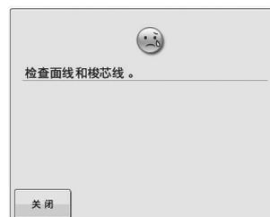
面线断线，线露在线张力盘或导线槽外面，或者机器未正确穿线。
