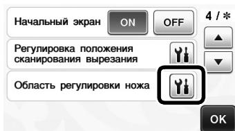
**2** Нажмите или , чтобы выбрать область регулировки ножа, затем нажмите кнопку "OK".
