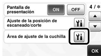
**2** Toque o para seleccionar el área de ajuste de la cuchilla, y luego toque la tecla “OK”.
