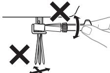
**5** 讓車針的平坦面朝向本機背面，將車針插入直到頂住車針止擋處。然後用螺絲起子鎖緊針留螺絲。
