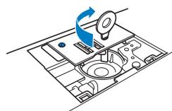
Tournez le volant pour vérifier que les griffes d'entraînement se déplacent librement et n'entrent pas en contact avec les bords des fentes dans la plaque d'aiguille.
