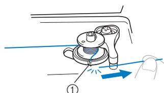
① Fenda de guia na base do enchedor de bobina (com cortador)
