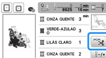
2 Pressione para desligar a função de cortador de linha automático.
