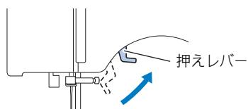
20 糸の端を抑えの間に通して後ろ側に5cmほど引き出します。
