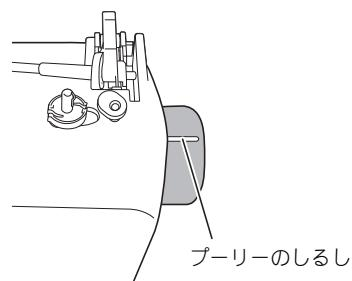
・針が正しく上に上がっていない場合、上糸を通すことができません。ブーリーのしるしが上図のように上にきている状態が、正しい位置です。この位置にきていないときは、必ず針上下スイッチで針を上に上げてブーリーのしるしが上側にくるようにしてから、以降の操作をしてください。
