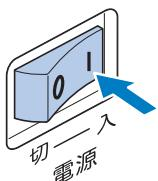
▶ 電源が入り、手もとライトが点灯し、LCD(液晶画面)が表示されます。
