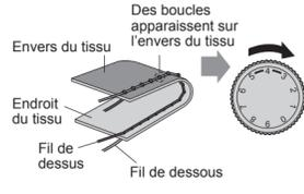
**Solution:** Augmentez la tension en réglant le sélecteur de tension supérieure sur un numéro supérieur.
