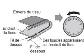
**Solution:** Réduisez la tension en réglant le sélecteur de tension supérieure sur un numéro inférieur.
