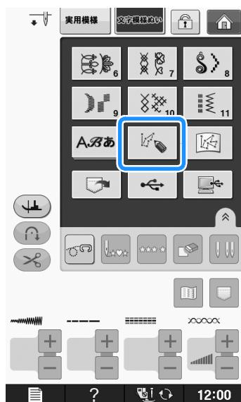
3 □を使って、ペンをマイイラスト用紙の最初のポイントの座標に移動します。
