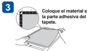
**3** Coloque el material en la parte adhesiva del tapete.
