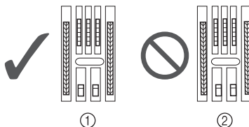
① Juiste stand van transporteur ② Onjuiste stand van transporteur
