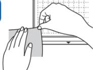
Prima di applicare il materiale al supporto, utilizzare un angolo del lato adesivo del supporto per provarne l'adesività.
