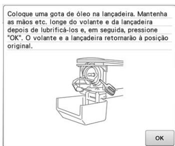
**7** Depois de lubrificar, coloque a caixa da bobina na lançadeira e feche a tampa da lançadeira. (Consulte a página 34.)
