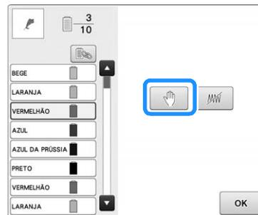
→ A marca
