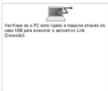
**A máquina falhou ao se comunicar com o PC no modo Link.**
