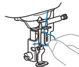
**12** Puxe a ponta da linha, que foi passada pela guia da linha da barra da agulha, para a esquerda, em seguida, passe a linha pela canaleta da guia da linha do passador e puxe-a firmemente pela parte da frente, inserindo-a na fenda do disco da guia da linha do passador marcado com “7”, de ponta a ponta.
