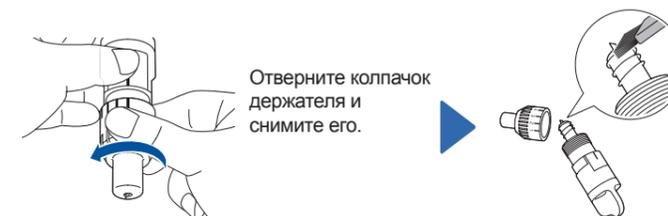
Отверните колпачок держателя и снимите его.
