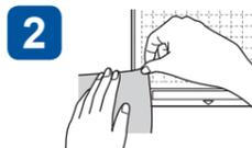
Перед прикреплением материала к мату проверьте фиксацию материала на одном из углов клейкой области.
