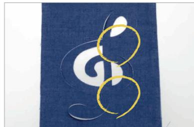
☀ Pour découper proprement, un support avec une adhérence adéquate, une lame et une pression de découpe appropriées sont nécessaires. Remplacez le support standard par un autre et ajustez les réglages.
