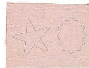
☀ Le réglage de la lame est insuffisant. Ajustez le réglage sur le porte-lame.
