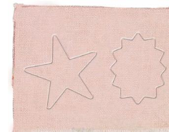
☀ El ajuste de la escala de la cuchilla es insuficiente. Defina el ajuste en la escala del soporte. **Sugerencia: es posible que solo deba ajustarlo en incrementos de 0,25, no en un número completo.**
