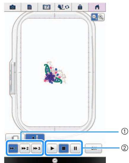
① Wählen Sie die Simulationsgeschwindigkeit aus. Die Geschwindigkeit kann auch während der Simulation geändert werden.
