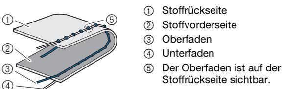
Drehen Sie das Fadenspannungsrad im Uhrzeigersinn, um die Oberfadenspannung zu erhöhen.
