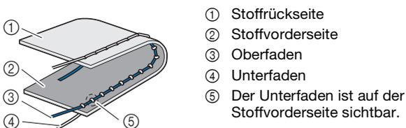
Drehen Sie das Fadenspannungsrad gegen den Uhrzeigersinn, um die Oberfadenspannung zu verringern.
