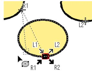
Aparece una línea de puntos entre el punto de entrada (o salida) que se traslada y la cruz que indica el punto de salida (o entrada) del patrón anterior (o siguiente).
