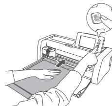
Alignez le bord du support sur les guides se trouvant sur les côtés droit et gauche de la fente d'entraînement, puis insérez-le sous les rouleaux d'entraînement. Placez doucement votre main au centre du support, puis poussez-le doucement vers l'avant tout en appuyant sur le bouton « d'entraînement » du panneau de commande. Quand vous appuyez sur le bouton d'entraînement, le support est automatiquement alimenté vers la position adéquate.
