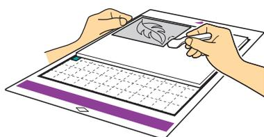
**9** (Con hojas metálicas) Retire la hoja metálica (con las hojas protectoras colocadas) del tapete para grabado en relieve y, a continuación, despegue las dos hojas protectoras de la hoja metálica utilizando las pestañas.
