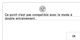
Ce message apparaît lorsque le pied à double entraînement ne peut être utilisé avec le point actuel. Sélectionnez un autre point.
