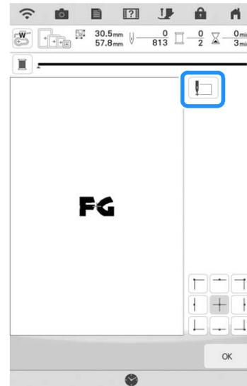
→ L'aiguille est positionnée sur le coin inférieur gauche du motif. Le chariot se déplace de sorte que l'aiguille soit correctement positionnée.
