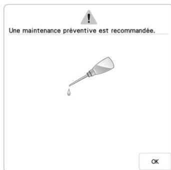
Ce message s'affiche lorsque la machine a besoin d'une maintenance.
