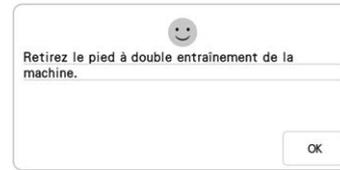
Ce message apparaît lorsque vous essayez de commencer à broder, le pied à double entraînement fixé à la machine. Retirez-le avant d'activer le mode de broderie.
