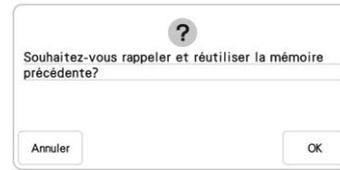
Ce message s'affiche si la machine est mise hors tension en cours de broderie, puis remise sous tension. Appuyez sur **OK** pour remettre la machine dans l'état dans lequel elle se trouvait avant sa mise hors tension (emplacement du motif et nombre de points). Suivez la procédure décrite sous « Rupture du fil pendant la broderie » à la page 57 pour aligner la position de l'aiguille et broder le reste du motif.
