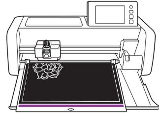
**9** ラインストーン模様のカットが完了したら、マットを排出し、テンプレートシートをマットから剥がします。
