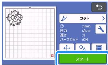
**7** テンプレートシートの剥離紙が切られている場合は、ハーフカットの圧力を下げて調整してください。
