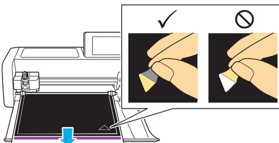
**8 Wenn der Testschnitt des Musters richtig ausgeführt wurde, tippen Sie auf „Start“ und schneiden das Strasssteinmuster.**
