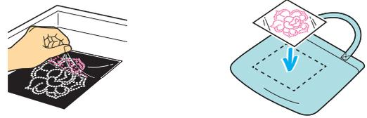
**16** Legen Sie einen Stoff unter und auf den Stoff mit der angebrachten Transferfolie und drücken Sie dann mit einem Bügeleisen bei mittlerer Temperatur (140 bis 160 °C (284 °F bis 320 °F)) ca. 45 bis 60 Sekunden auf den oberen Stoff.
