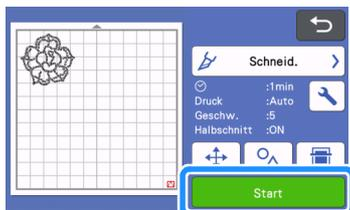
**7 Wird die Schutzfolie des Vorlagenblatts durchgeschnitten, verringern Sie den Schneiddruck (Halbschnitt).**
