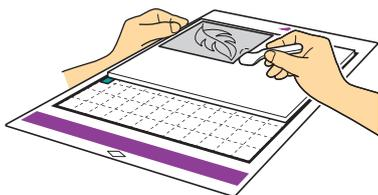
**10 (Für Metallbleche) Entfernen Sie das Metallblech (mit angebrachten Schutzfolien) von der Reliefmatte, und ziehen Sie dann mit den Laschen beide Schutzfolien vom Metallblech ab.**
