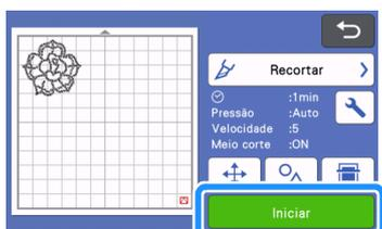
**7** Se o suporte do gabarito for recortado, ajuste a Press. d Corte (Meio corte) para diminuir a pressão.
