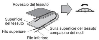
**Soluzione:** Diminuire la tensione ruotando il regolatore di tensione superiore su un numero inferiore.
