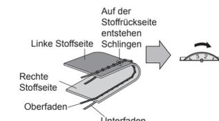
**Lösung:** Erhöhen Sie die Spannung, indem Sie die Oberfadenspannung auf einen höheren Wert einstellen.
