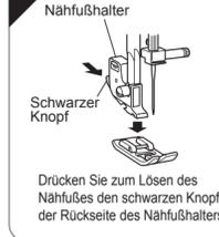
Drücken Sie zum Lösen des Nähfußes den schwarzen Knopf an der Rückseite des Nähfußhalters.
