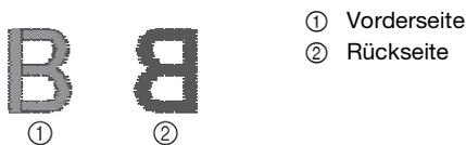
Verstellen Sie in diesem Fall die Schlitzschraube (-) im Uhrzeigersinn um ca. 30-45 Grad, um die Unterfadenspannung zu erhöhen (achten Sie darauf, dass Sie die Schraube nicht überdrehen).
