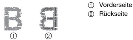
Drehen Sie in diesem Fall die Schlitzschraube (-) ca. 30-45 Grad gegen den Uhrzeigersinn, um die Unterfadenspannung zu verringern. Achten Sie darauf, dass die Schraube nicht zu locker sitzt.
