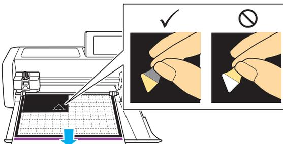
**11** Si el patrón de prueba se ha cortado correctamente, seleccione la tecla “inicio” y corte el patrón de pedrería.
