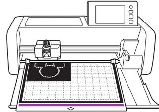
**12** Cuando se haya terminado de cortar el patrón de pedrería, retire el tapete y despeje la plantilla.
