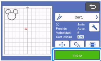
**10** Si se ha llegado a cortar el soporte de la hoja de plantilla, disminuya el ajuste Presión corte (Cort mitad).
