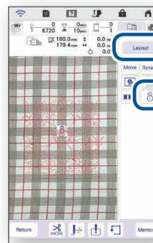
3. Wählen Sie mit dem Aufkleber
