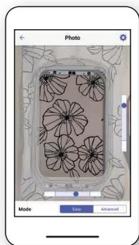
5. Halten Sie Ihr Smartgerät parallel zum Stickrahmen, sodass zwei Punkte in Rechtecken zentriert sind.
