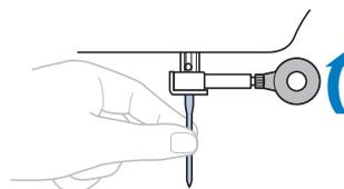
Installez l'aiguille double de la même façon.
