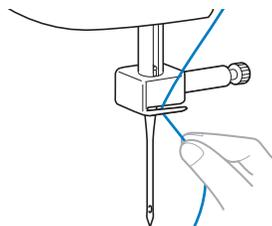
**11** Enfilez l'aiguille selon les étapes ⑬ et ⑭ dans « Enfilage supérieur » (page 28) ou les étapes ② à travers ⑨ dans « Utilisation de l'enfile-aiguille (pour les modèles équipés de l'enfile-aiguille) » (page 28).
