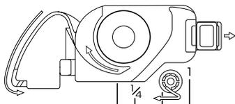
**1** Relevez l'aiguille dans sa position la plus haute en tournant la molette vers vous (dans le sens inverse des aiguilles d'une montre) ou appuyez sur (+) (touche de positionnement de l'aiguille) (pour les modèles équipés de la touche de positionnement de l'aiguille), et soulevez le levier du pied presseur.
