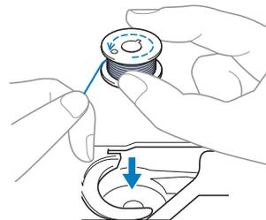
Si la canette est insérée avec le fil qui se déroule dans le mauvais sens, la couture s'effectuera avec une tension de fil incorrecte.
