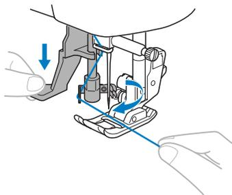
► L'extrémité de l'enfile-aiguille tourne vers vous et le crochet passe dans le chas de l'aiguille.
