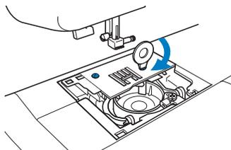
Tournez la molette pour vérifier que les griffes d'entraînement se déplacent en douceur et n'entrent pas en contact avec les bords des fentes de la plaque à aiguille.
