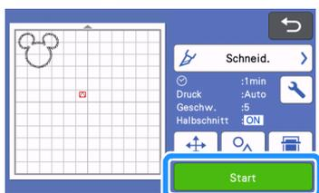
**10 Wird die Schutzfolie des Vorlagenblatts durchgeschnitten, verringern Sie den Schneiddruck (Halbschnitt).**
