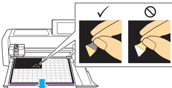
**11 Wenn der Testschnitt des Musters richtig ausgeführt wurde, tippen Sie auf „Start“ und schneiden das Strasssteinmuster.**
