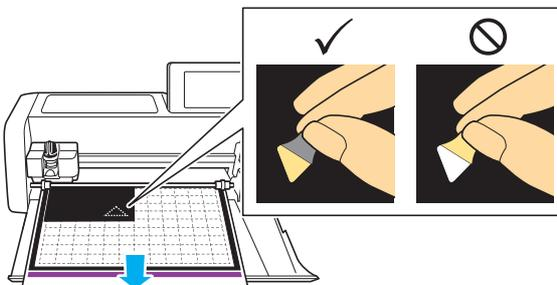
**11** Se il taglio di prova del disegno è stato eseguito correttamente, toccare il tasto "Avvio" e tagliare il disegno per gli strass.
