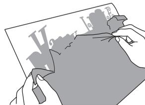
Wenn Sie große nicht benötigte Teile abziehen, kleben diese aneinander oder an den gewünschten Teilen, wodurch das Entgittern schwer wird.
