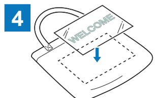
Legen Sie die in Schritt ③ geschnittene Folie mit dem Trägermaterial nach oben auf die Zielfläche, wie zum Beispiel Stoff (\*2).
