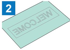
Schneiden Sie das gewünschte Muster mit der Halbschnittfunktion der Schneidmaschine. (\*1)
