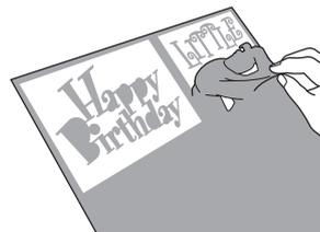
Wenn Sie einen Entgitterrahmen schneiden, werden die nicht benötigten Teile in kleinere Teile unterteilt. So wird das Entgittern einfacher.
