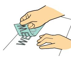
Befestigen Sie die Applikationsfolie\*<sup>1</sup> an dem Bereich des Trägermaterials, auf dem das Muster ist. (\*<sup>2</sup>)
