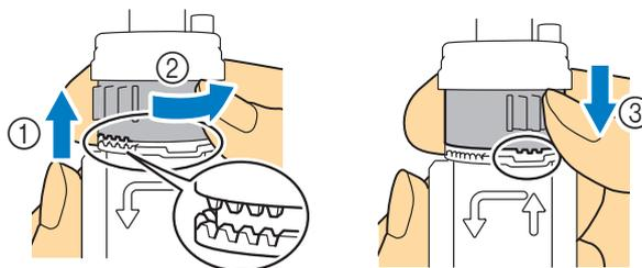
**4** Tout en maintenant le support pour calligraphie par le bas, soulevez la pointe du stylo en dehors de la rainure, faites tourner le stylo de 180 degrés dans le sens des aiguilles d'une montre de sorte que la pointe du stylo revienne dans la rainure du dispositif de réglage pour stylo.
