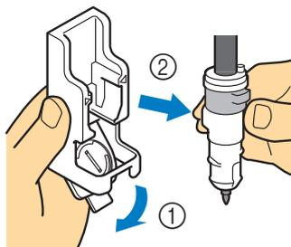
**10** Tout en maintenant le porte-stylo pour la calligraphie, insérez-le dans le chariot de la machine et appuyez sur le levier de verrouillage du support à lame de découpe/porte-stylo.
