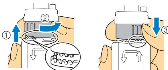
**4** Tenendo premuta la base per calligrafia, estrarre la punta della penna dalla scanalatura sollevandola, ruotare la penna di 180° in senso orario in modo che la punta della penna si inserisca di nuovo nella scanalatura del dispositivo di regolazione penna.
