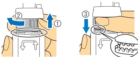
**8** Verificare che la punta della penna per calligrafia si trovi nella scanalatura del dispositivo di regolazione penna.
