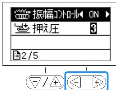
→ 模様の振り幅がスピードコントロールレバーで調節できるように設定されました。
