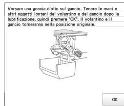
7 Al termine della lubrificazione, inserire la custodia della spolina all'interno del crochet e chiudere il coperchio del crochet. (pagina 35)
