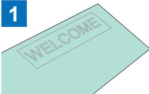
1 Realize um meio corte do padrão desejado com a máquina de cortar.
