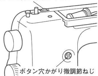
2. **ぬい目の長さ調節ダイヤル**を回し、右側のぬい目の長さを調節します。
