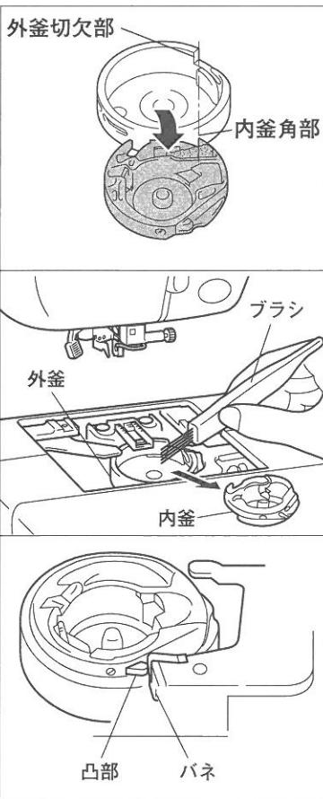
3. プーリーを手前に回し、外釜切欠部と内釜角部の位置を合わせて内釜を取り外してください。
