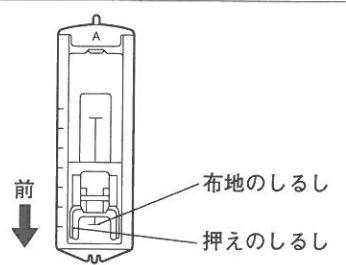
3. <A>押え（ボタン穴かがり押え）をセットし、布地を入れ、押えを押しながら布地のしるしに押えのしるしを合わせて、押えを下げてください。
