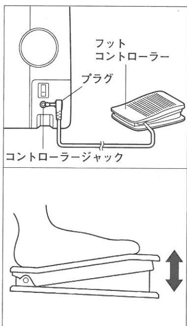
1. 電源スイッチを切って、フットコントローラーのプラグをジャックに差し込んでください。
