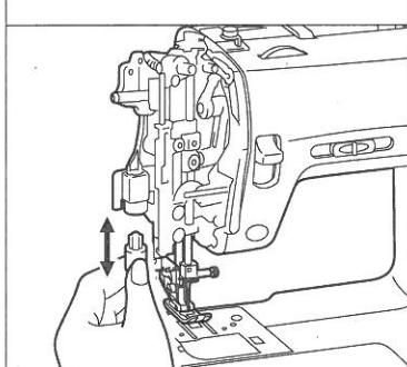
4. ランプのガラス部分が冷えてから、ランプを引き抜き、新しいランプを取り付けてください。
