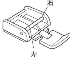
1. 押えの右側を押えホルダーに付け、打ち合わせの下になる方を先にぬってください。
