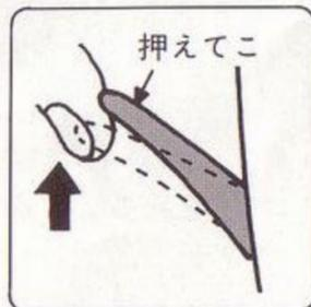
※送り込みの悪い布地を使用する場合は押えの強さを1~3の範囲で調整して下さい
