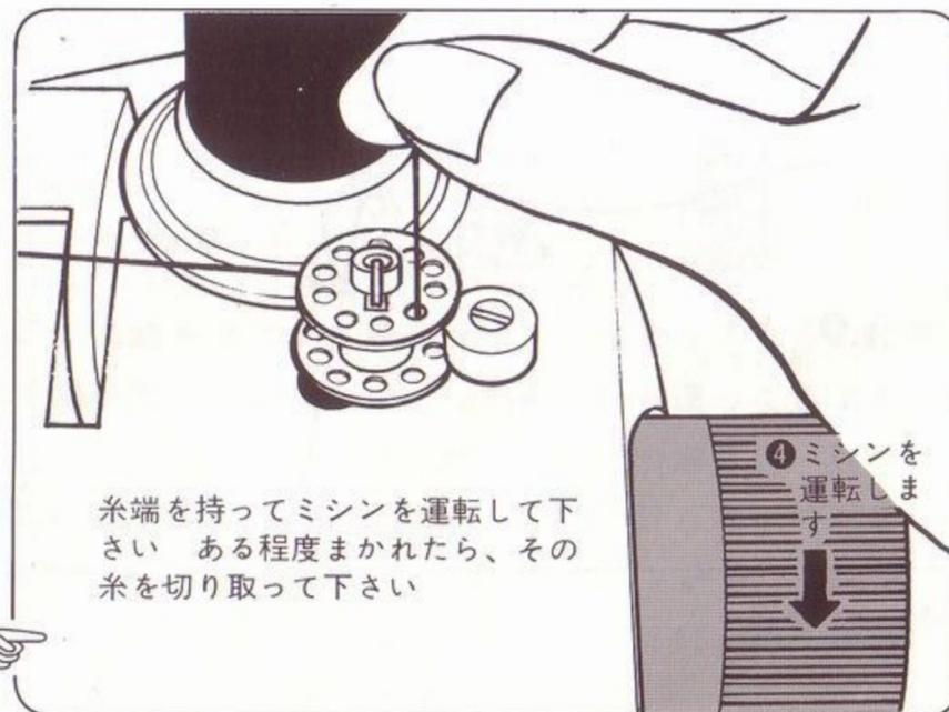
☆ボビンに糸が巻き終ると、ボビンの回転は自動的に停止します。ミシンは回転しつづけますのでご注意ください。コントローラーをふむのをやめてミシンを停止させ、ボビンを左側に押してボビン押えからはずし、ボビンを取り出し、糸を切ります。
