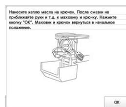
7 После смазки вставьте шпильный колпачок в челночное устройство и закройте крышку челночного устройства. (с. 35)
