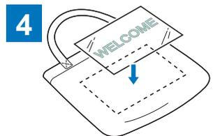
4 Con el soporte cara arriba, coloque la hoja cortada en el paso 3 sobre la superficie de destino, como por ejemplo una tela (\*1).
