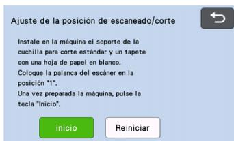
**5** Después de comprobar que la palanca del escáner (en el lado izquierdo de la máquina) se encuentra en la posición “1”, toque la tecla “inicio” para empezar a cortar.
