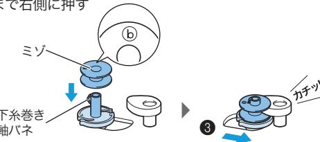
4. 糸をボビンに時計回りに5~6回巻き付け、ボビン受け座のガイドミゾにひっかけ、糸の端を切れます。
