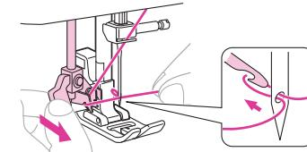
14. 押えレバーを上げ、糸の輪を後ろ側へ引き、針穴から糸の端を引き出す
