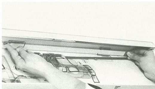
(15) ケースの編出シ押エバネ (2ヶ所) を開き編出シを取り出します。
